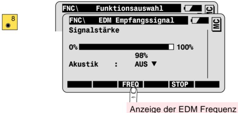
Die Stärke des reflektierenden Signals wird in Prozent angezeigt. Durch leichte Bewegung des Instruments in horizontaler und/oder vertikaler Richtung und gleichzeitiger Beobachtung der Signalstärke kann das Signalmaximum ermittelt werden. Dies kann v.a. bei weit entfernten Zielen unter schlechten Sichtverbindungen hilfreich sein.
